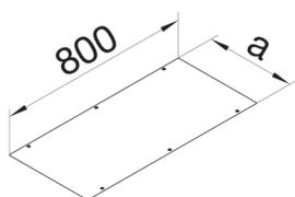
**Abdeckung blind für estrichbündige Bodenkanäle Stahlblech zu BKF/BKW 350x800mm**
