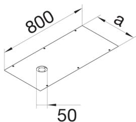
**Abdeckung gestanz GBZ rund 50mm abdichtbar Stahlblech zu BKFD/BKWD 250x800mm**
