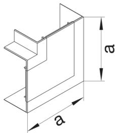
**Flachwinkel schnittkaschierend zu BR/A 68x170mm Oberteil 80mm hfr lackiert alu**
