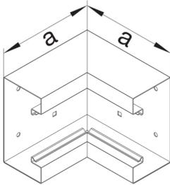
**Inneneck aus Grundprofil zu BRS 100x210mm Oberteil 80mm aus Stahlblech verzinkt**
