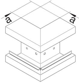
**Außeneck aus Grundprofil aus Stahlblech zu BRS 70x130mm Oberteil 80mm lichtgrau**
