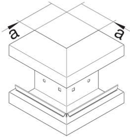
**Außeneck aus Grundprofil zu BRS 68x130mm Oberteil 80mm Stahlblech verkehrsweiß**
