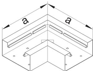
**Flachwinkel aus Grundprofil Stahlblech zu BRS 70x130mm Oberteil 80mm verzinkt**
