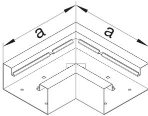
**Flachwinkel aus Grundprofil zu BRS 68x170mm OT 120mm aus Stahlblech lichtgrau**
