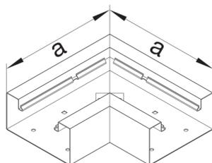
**Flachwinkel aus Grundprofil BRS 66x170mm Oberteil 120mm Stahlblech verkehrsweiß**
