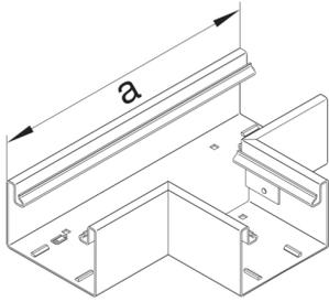
**T-Stück aus Grundprofil Stahlblech zu BRS 68x170mm Oberteil 80mm reinweiß**
