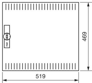
**Tür, univers, rechts, geschlitzt, RAL 9010, für Schrank IP3X, 500x550mm**
