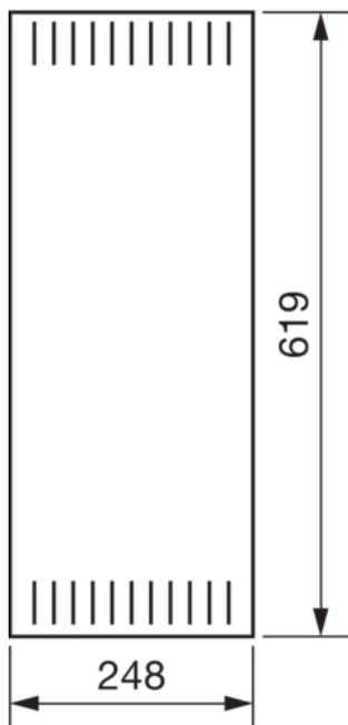
**Tür, univers, links, geschlitzt, m.90SL, RAL 9010 für Schrank IP3X 650x800mm**
