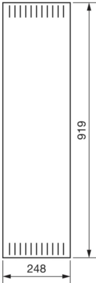
**Tür, univers, links, geschlitz, m.90SL, RAL 9010 für Schrank IP3X 950x800mm**
