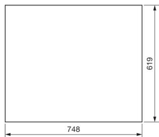
**Tür, univers, links, geschlossen, RAL 9010, für Schrank IP44 650x1300mm**
