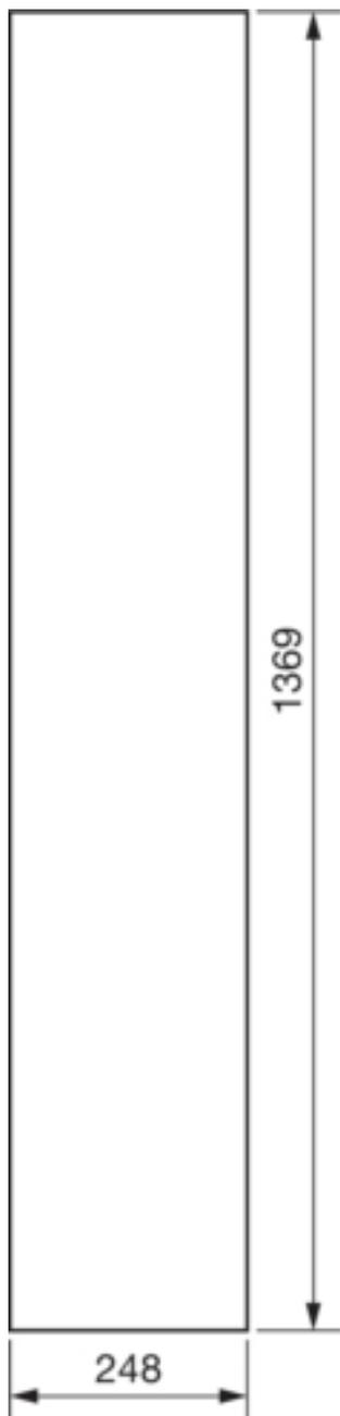
Tür, univers, links, geschlossen, RAL 9010, für Schrank IP44 1400x800mm
