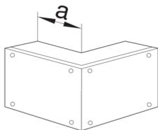
Formteil als Systemzubehör für feuerwiderstandsfähigen Leitungsführungskanal FWK90 - E90 nach DIN4102-12 zum Funktionserhalt bei Wand- und Deckenmontage und E30 nach DIN4102-12 zum Funktionserhalt bei abgehängter Montage.
