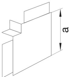
**Flachwinkel halogenfrei zu Leitungsführungskanal LF 25x25mm verkehrsweiß**
