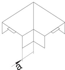
**Flachwinkel schnittkaschierend aus Stahlblech zu LFS 60x150mm verkehrsweiß**
