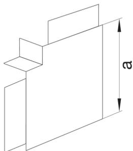
**Flachwinkel aus PVC zu Leitungsführungskanal LF/FB 60x230mm steingrau**
