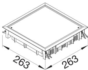
**Verschlussdeckel Q12 244x244mm für 5mm Bodenbelag aus Polyamid tiefschwarz**
